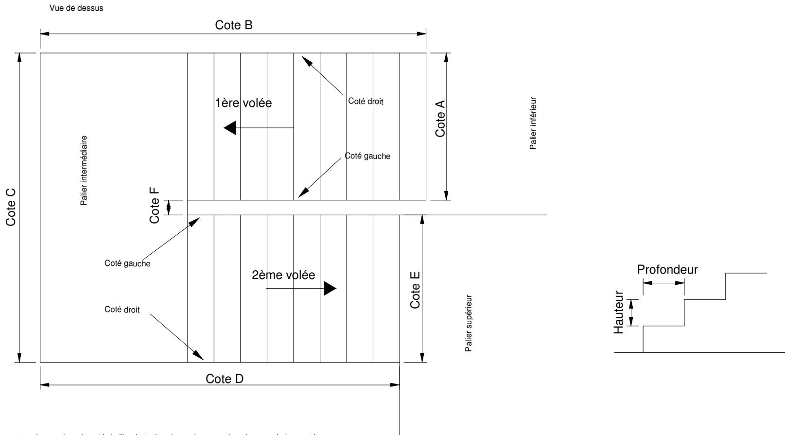
Prendre les cotes de marches du coté de l'implantation du garde-corps dans le sens de la montée.
